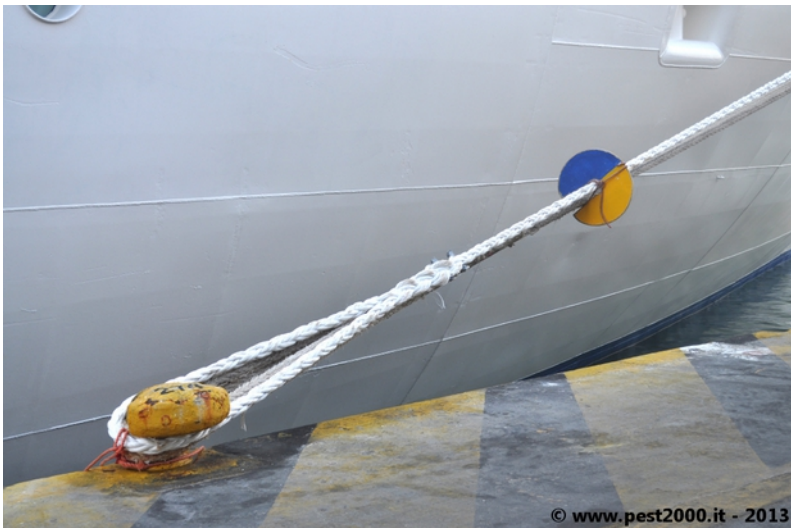
Un “rat disk” impedisce che i ratti possano raggiungere la nave risalendo lungo la gomena di ormeggio.
